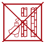
недостаточная тяга (Не используйте котел!)
