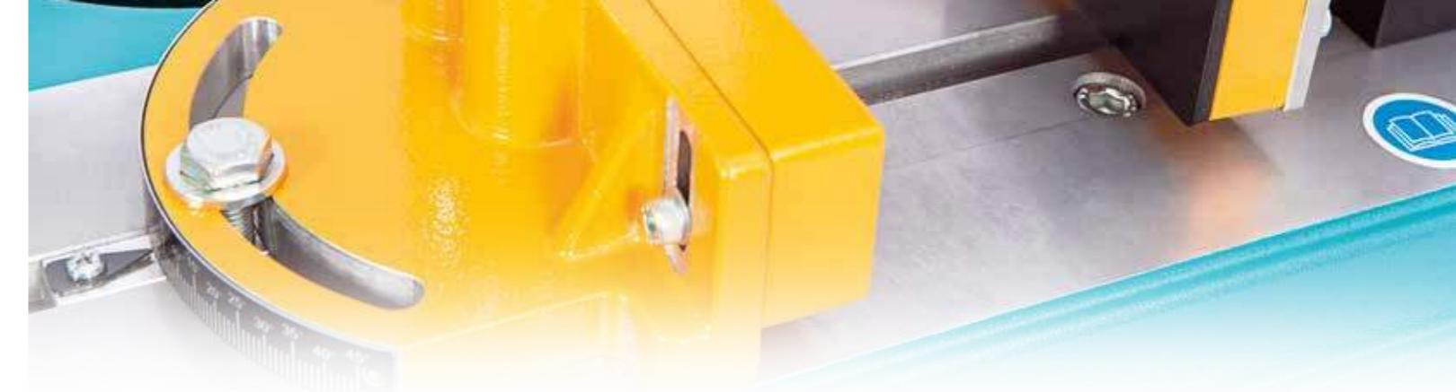
Alüminyum ve PVC profilleri hassas bir biçimde alıştırma işlemlerinde kullanılan hidro-pnömatik olarak çalışan kertme makinesidir.
